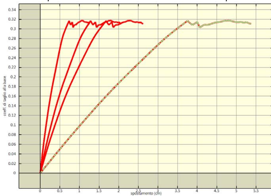
Analisi pushover "Pushover -X Massa + e" : curva di capacita'.
