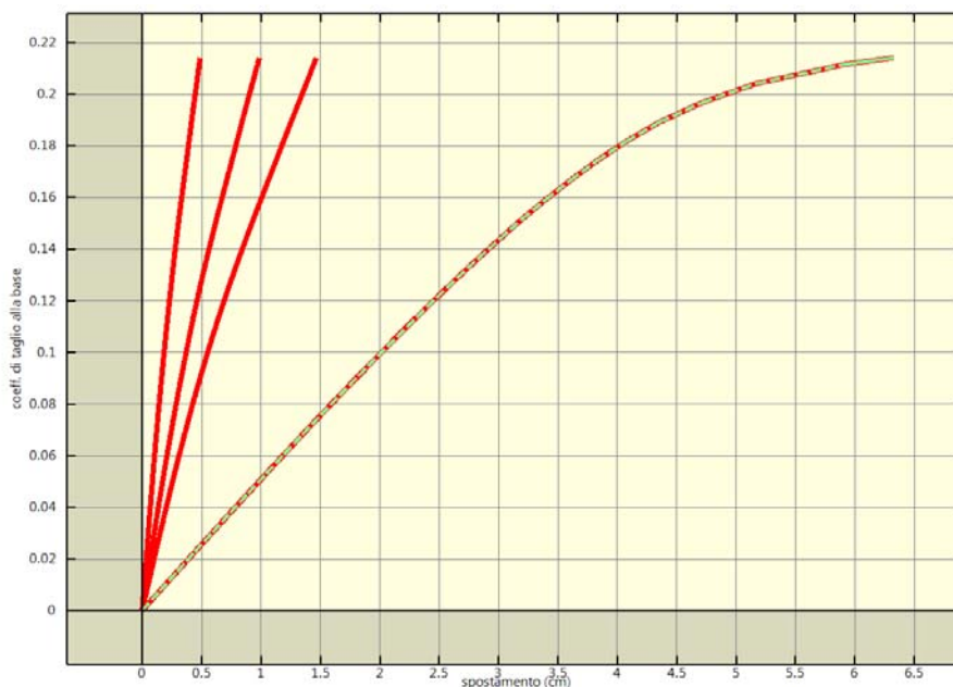
Analisi pushover "Pushover +X Triang" : curva di capacita'.
