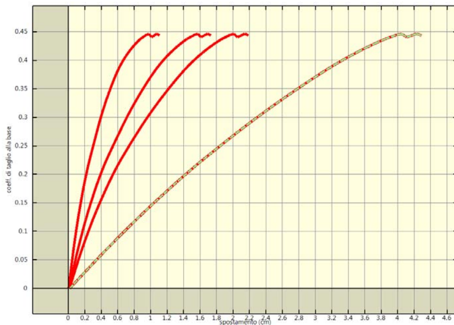
Analisi pushover "Pushover -Y Massa - e" : curva di capacita'
