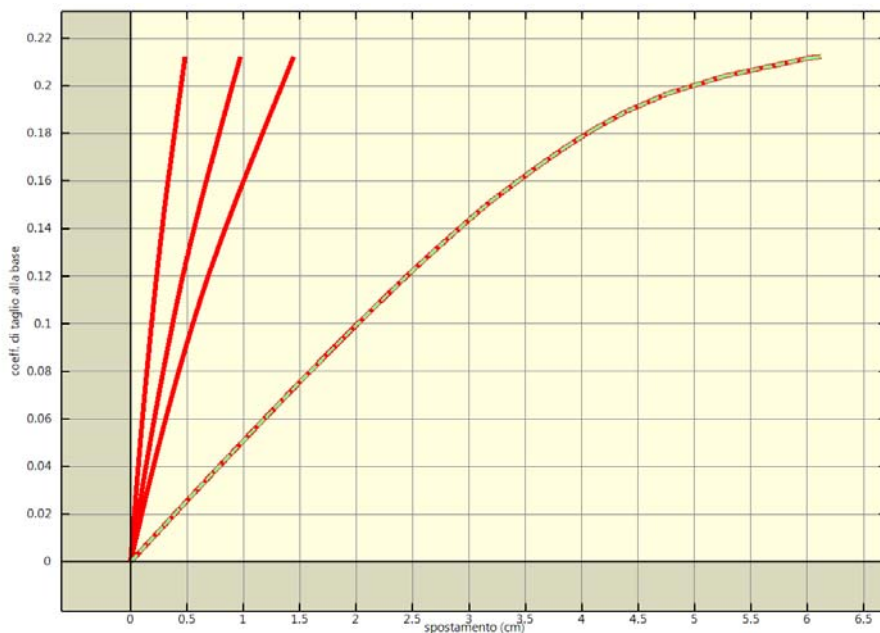
Analisi pushover "Pushover -X Triang - e" : curva di capacita'.
