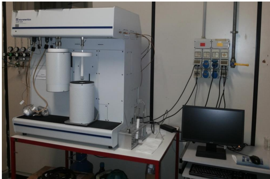
Strumento di fisorbimento installato presso i laboratori del CNR ITAE
