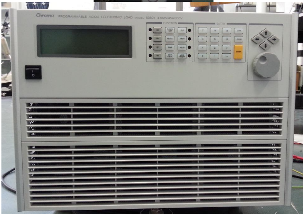
Alimentatore e carico per testing dispositivi
