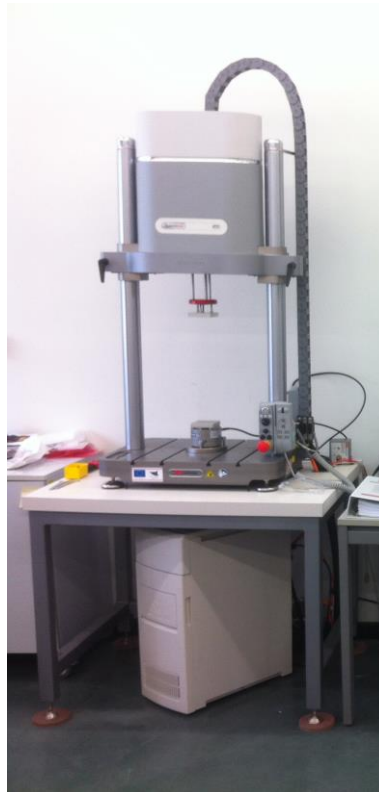
Macchina di prova con azionamento elettrodinamico, completo di accessori
