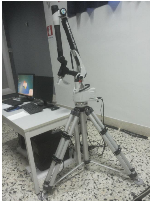
Sistema di reverse engineering composto da laser scanner e braccio articolato
