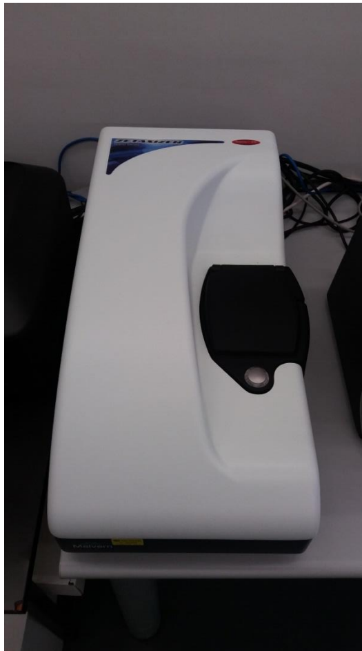
Sistema per analisi del potenziale ZETA attraverso laser doppler con tecnica elettroforetica
