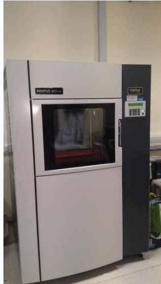
Macchina di Prototipazione Rapida basata su tecnologia FDM (Fortus400MC)
