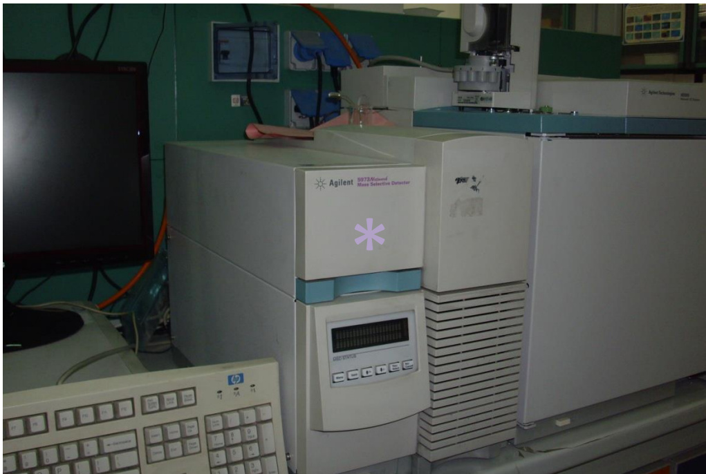
Gasromatografo e Spettrometro di Massa AGILENT (GC 6890N a ds; MS 5973N a sin)
