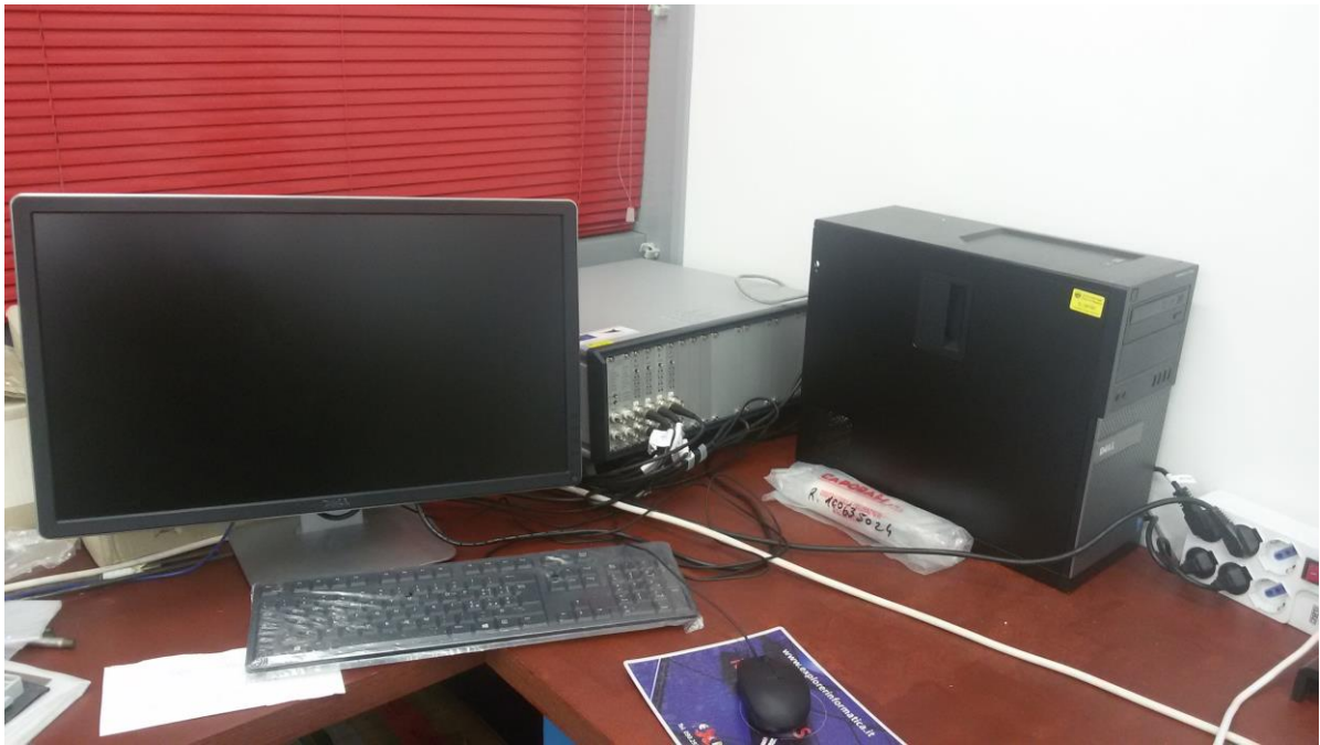
Sistema integrato di acquisizione di Emissione Acustica (EA) a multicanale
