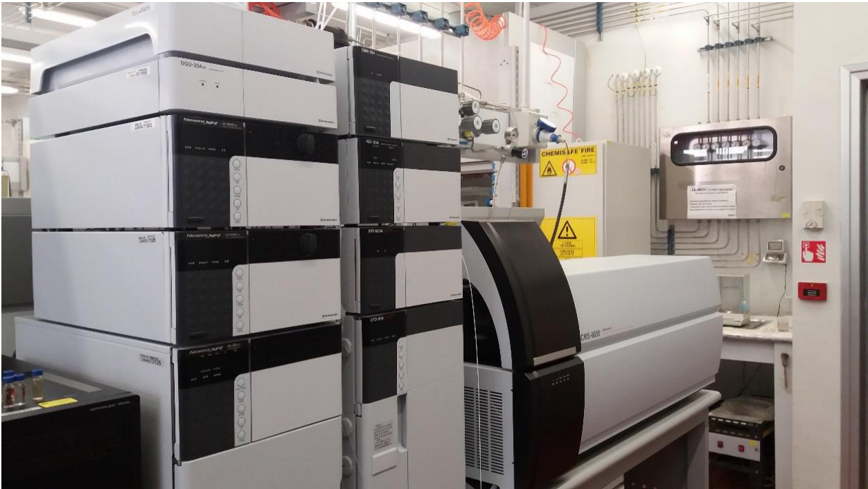
Sistema di Cromatografia liquida con detector ad indice di rifrazione, a serie di diodi e a spettrometria di massa (LC-MS)
