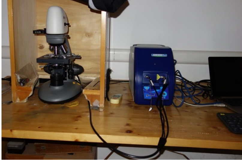
Spettrometro iRaman Plus con accoppiato microscopio ottico
