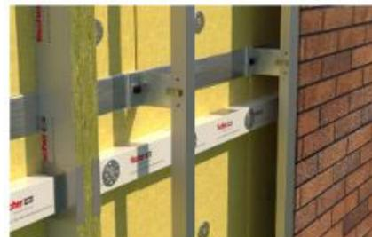
La barriera antincendio sarà ottenuta mediante l'applicazione di elementi Cavity FireStop Clad FCFcl della Fischer, idonei per le cavità, delle dimensioni di mm 1.200 x 1.000 x 100.
