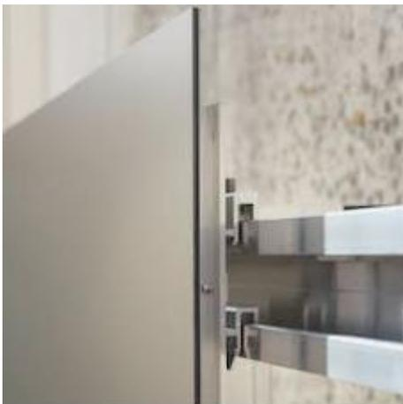
Lo spessore delle lamiere in alluminio sarà di cm 0,50, peso kg/mq 7,6, con verniciatura coil coating fluoropolimero, grado di assorbimento acustico as (ISO354) 0,05, isolamento acustico  $R_w$  (ISO 717-1) [dB]  $\geq 25$ , resistenza alla penetrazione termica R (DIN52612) 0,009, resistenza termica [°C] -50 a +80, di colore Silver.
