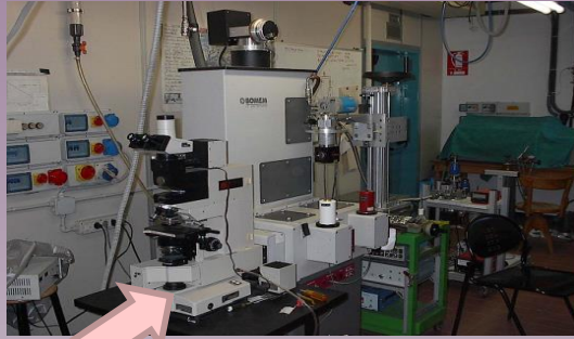
Bomem DA8 FT-IR spectrometer
