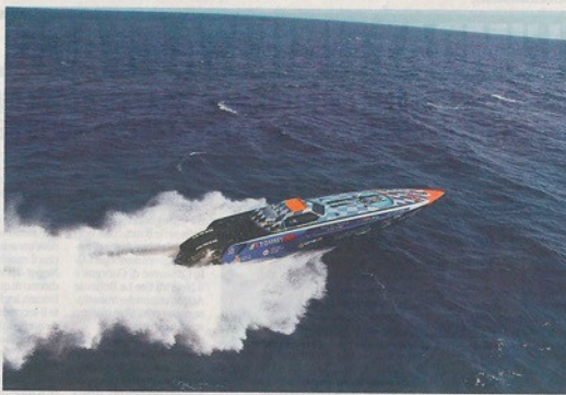
Tommy One, una Meta Marine, costruita in kevlar e fibra di carbonio, negli omonimi cantieri di San Benedetto del Tronto
