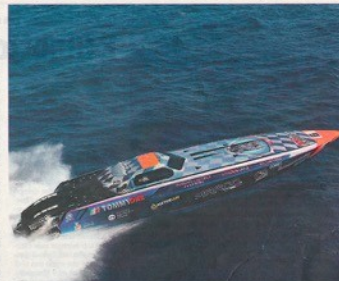
Tommy One, una Meta Marine, costruita in kevlar e fibra di carbonio nei cantieri di San Benedetto del Tronto
