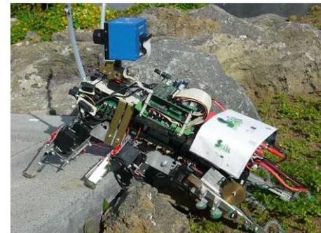
**Rover II** - un robot su ruote, di tipo differential drive, dotato di sensori di contatto, di distanza e di visione utilizzato per la prima sperimentazione degli algoritmi percettivi e la successiva ottimizzazione tramite campagne mirate. Il sistema percettivo è implementato a bordo tramite una scheda basata su FPGA [RI07-RI08].
