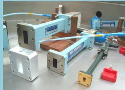
Il gruppo di ricerca studia il comportamento di una classe di materiali, quali liquidi e vetri ionici, importanti nella produzione di batterie e sensori ad alte prestazioni. L'analisi sperimentale consiste nello studio della risposta di questi materiali in funzione della temperatura quando sono sottoposti a campi elettromagnetici variabili, nel range delle microonde.
